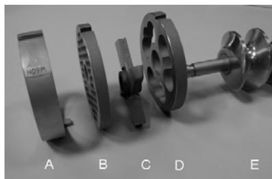
verwechselt werden können. Sollten Sie noch Lochscheiben ohne zweite Ausnehmung für die „Nase“ besitzen, können diese nicht mehr verwendet werden und müssen ausgetauscht werden!
