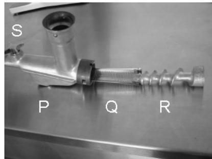
Die Fruchtpresse wird in die Nabe des A 2-2 eingeführt, der Klemmhebel nach unten gedrückt und durch einen leichten Schlag mit der Handkante auf die Klemmhebelfläche fest eingespannt.
