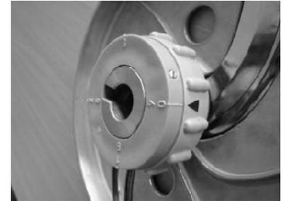
Die Reib- und Streifenscheiben werden mit einem Ausziehgriff (optional erhältlich) ebenfalls durch Linksdrehung von der Antriebsnabe abgezogen. Der Wechsel der Reib- oder Schneidscheibe darf nur bei ausgeschaltetem Antrieb vorgenommen werden!
