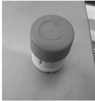
Der NOT – Halt – Schlagschalter dient zum sofortigen Stopp der Maschine in einer Notsituation. Er wird durch schlagartiges Betätigen mit der Hand eingedrückt. Die Entriegelung erfolgt durch eine leichte Rechtsdrehung (siehe Pfeil auf dem Schlagschalter bzw. oben im Bild)
