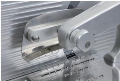
\*\*Entnehmbare Edelstahlplatte zur Reinigung in der Spülmaschine
